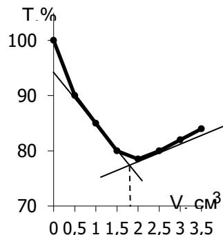
Рисунок 1 – Кривая фотоколориметрического титрования воды раствором комплексона.
